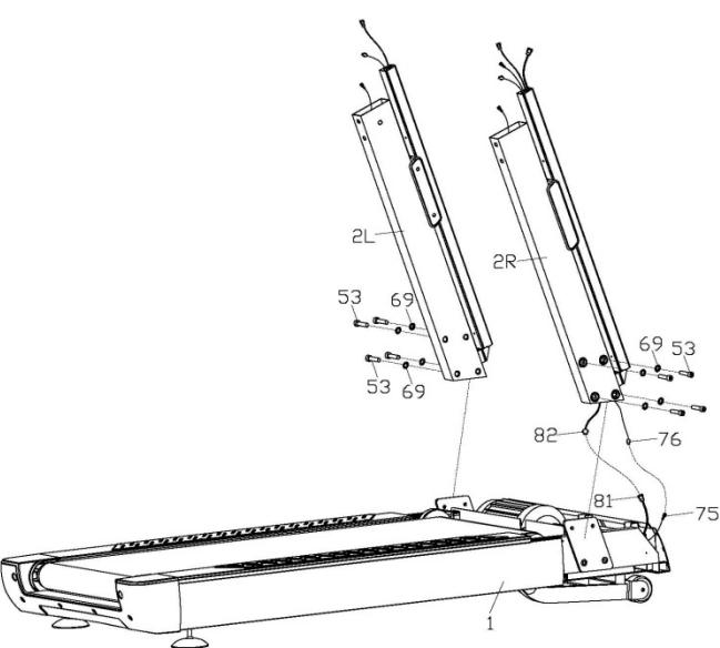
Соедините нижний провод питания задней подсветки (75) с соединительным проводом питания задней подсветки (76) и нижний провод консоли (81) - с соединительным проводом (82).
