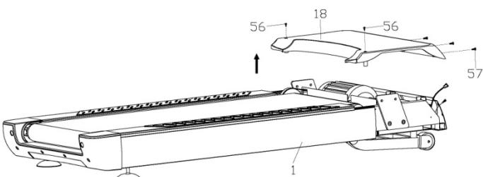
Отверните винты (56), винты (57) и снимите кожух моторного отсека (18) с основной рамы (1).
