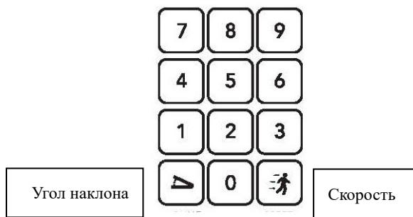
Одним нажатием кнопки СКОРОСТЬ или УГОЛ НАКЛОНА вы можете быстро изменить необходимый параметр. Например, для того чтобы установить скорость на значение 6,5 км/ч необходимо нажать следующую комбинацию: кнопок 6-5-СКОРОСТЬ;
