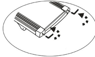
Поворачивайте против часовой стрелки чтобы уменьшить натяжение полотна
