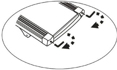
Поворачивайте по часовой стрелке чтобы увеличить натяжение полотна
