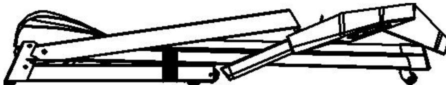
Шаг 2: Аккуратно, удерживая руки на поручнях консоли, поднимите вверх консольные стойки (как показано ниже). Поместите винт M8x40 с левой и правой стороны. Установите винт M8x15 на задней стороне в нижней части консольной стойки и хорошо затяните.
